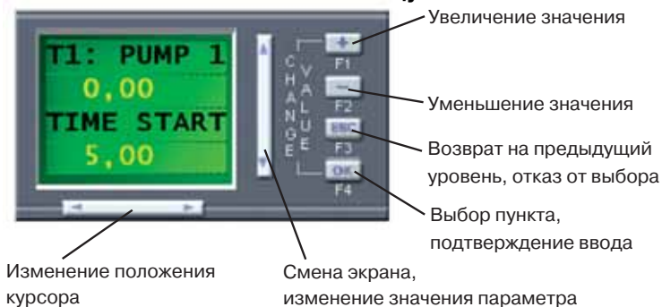
Рис. 3. Работа с кнопками управления логического модуля
